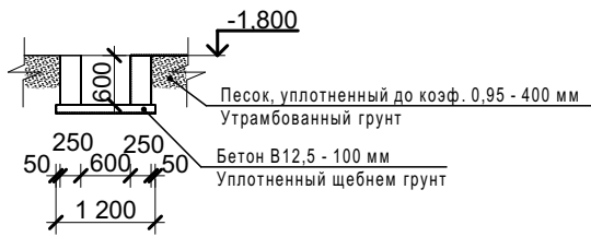
4-4 Конструкция приемка для установки насоса
